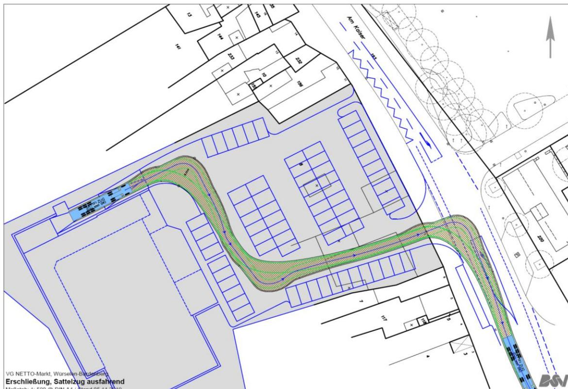
**Anlage 2** Dynamische Schleppkurve für einen ausfahrenden Sattelzug (L=16,50m) nach der Warenanlieferung von der Laderampe im Norden des NETTO-Marktes
