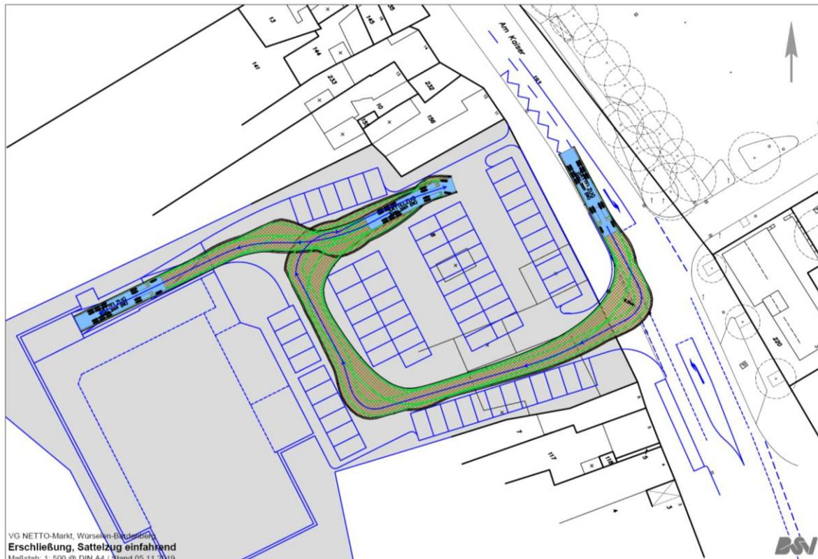
**Anlage 1:** Dynamische Schleppkurve für einen einfahrenden Sattelzug (L=16,50m) zur Warenanlieferung an die Laderampe im Norden des NETTO-Marktes
